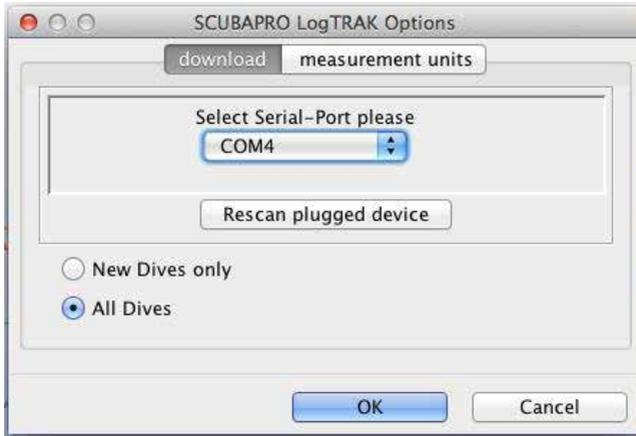
Aladin TEC 3Gドングル用に使用するCOMポートを選択します。
