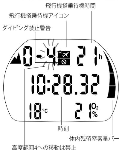
ダイビング終了後の5分間は、時刻、「飛行機搭乗待機時間」、「飛行機搭乗待機警告」（該当する場合）、現在の高度範囲、移動が禁止される高度範囲が画面に表示されます（->38）。
