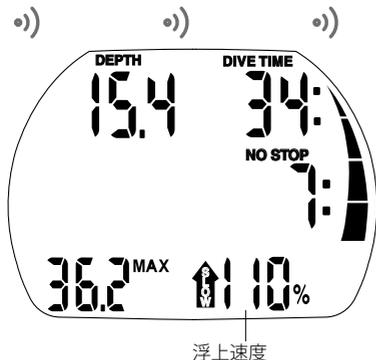
最適な浮上速度は、深度に応じて毎分7~20mです。この情報は、参考となる可変浮上速度に対する比率として表示されます。浮上速度が設定値の100%をオーバーすると、「SLOW」という黒い矢印が表示されます。浮上速度が140%をオーバーすると、この矢印が点滅を始めます。浮上速度が110%以上になるとアラーム音が鳴ります。アラーム音は、指定浮上速度に対する超過率に比例して強くなります。
