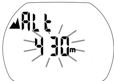
高度表示を、現在の高度に調整します。
