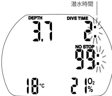
0.8m以深に滞在した経過時間が、潜水時間として分単位で表示されます。それより浅場での経過時間が潜水時間に加算されるのは、ダイバーが浮上後5分以内に0.8mより深く再潜行した場合のみです。潜水時間中は、数字の右側のコロンが1秒間隔で点滅します。表示可能な最長潜水時間は199分です。
