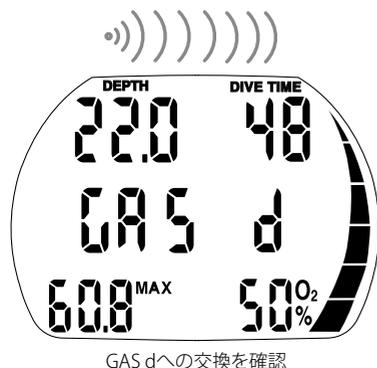
いつでも、 $\text{Ⓜ}$ を押して元のガスをアクティブにするか、ガス交換を確認するのをやめて、交換手順を中断することができます。
