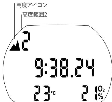
本製品は、表示をオフにしても、60秒ごとに大気圧を測定しています。高度が有意に上昇したことを検出すると、自動的にオンになり、新しい高度範囲 (1-4) と体内残留窒素排出時間が表示されます。現在表示されている体内残留窒素排出時間は、現在の高度に合わせて調整された時間です。この調整時間内にダイビングを開始すると、体内で残留窒素の排出が進行中なので、「反復潜水」と見なされます。
