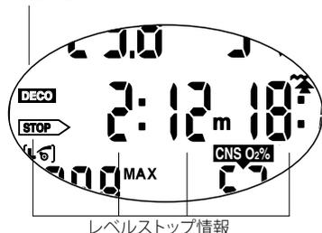
減圧停止が必須になると、 シンボルが表示されます。トータル浮上時間に、減圧停止の時間も加算されます。
