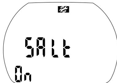
1. を押して、選択した水質タイプの変更を確認します。「on」または「off」が点滅を始めます。「Salt on」は海水、「salt off」は淡水です。
