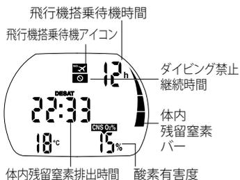
時刻表示で $\odot$ を押すと、体内残留窒素排出時間\*を確認できます。体内残留窒素排出時間は、酸素有害度、体内残留窒素、マイクロバブルの軽減のいずれかから、時間がより長くなるものを選んで計算されます。
