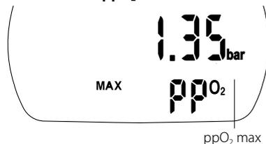
1. を押して、ppO<sub>2</sub> maxを変更することを確認します。現在の値が点滅を始めます。
