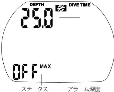
1.  $\odot$ を押して、アラームの深度を変更するかアラームをオン/オフにすることを確認します。深度が点滅を始めます。
