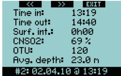
このページではOTU情報が表示され、センターボタン>>を押すと、次にガリレオ標準SWと同様にMBレベルが表示され、さらに>>ボタンを押すと、タンク情報が表示されます。
