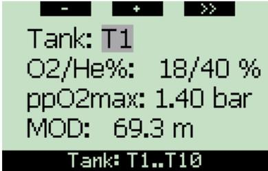
メイン表示(ショートカット)で左ボタンを長押し又はMENU-> O2 settings (enter)でタンクの内容を変更することができます。灰色のカーソルがハイライト表示されているときは、+ または - ボタンでスクロールすることができます。>> ボタンで、変更するタンクを選択します。
