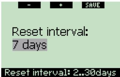
+/- ボタンを押す事によって2~30日間 OTUリセット間隔を選択できます。例えば、あなたが7日間を選択すると、OTU値と限界は7日後にダイビングなしでリセットされます。
