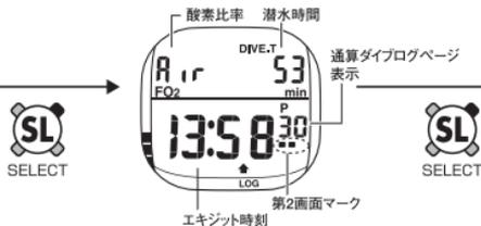
SELECTスイッチを押すと、最新のダイブログの第2画面が表示されます。上図はAIR(圧縮空気、酸素比率21%)を使用し、潜水時間53分、エキジット時刻13時58分を示します。
