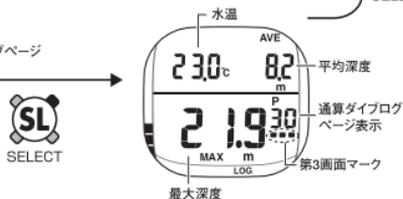
SELECTスイッチを押すと、最新のダイブログの第3画面が表示されます。上図は最大深度時水温が23°C、平均深度8.2m、最大深度21.9mを示します。SELECTスイッチを押すと、ダイブヒストリー画面に戻ります。
