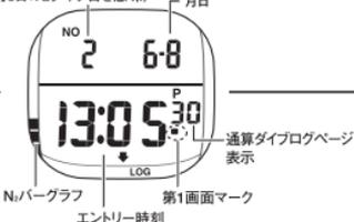
タイムモードからMODEスイッチを4回押して、ダイブヒストリー画面(ダイブログモード)へ。
