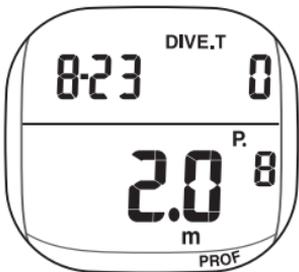
①から2回続けてSELECTスイッチを押すか、②でダイブプロフィールをカウントアップ中にSELECTスイッチを押すと、2つ前のダイブプロフィールを表示します。
