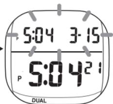
LOCKスイッチを押すと、上段のデュアルタイムとその月日が点滅します。
