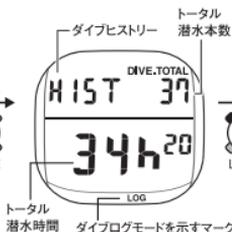
タイムモードでMODEスイッチを4回押し、ダイブログモードへ移行。最初の画面がダイブヒストリー画面です。
