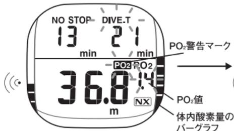
PO<sub>2</sub>値が1.3以下から1.4~1.5に増加すると、PO<sub>2</sub>警告マークとPO<sub>2</sub>値が15秒間点滅し、3秒間のアラームが2回鳴ります。その後、PO<sub>2</sub>警告マークが点灯し続けます。
