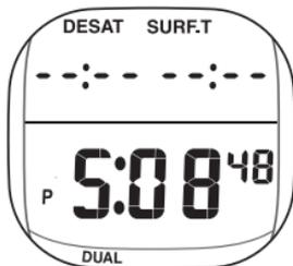
MODEスイッチを押すか3分経過するとデュアルタイムがメイン時刻として確定し、上段にデュアルタイムの曜日、月日を表示します。
