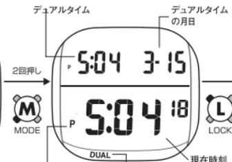
タイムモードからMODEスイッチを2回押すと、画面に「DUAL」のマークが現れ、デュアルタイムモードになります。
