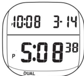
設定終了後、LOCKスイッチを押すと点滅が止まり、デュアルタイムモードになります。
