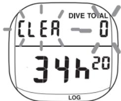
SELECTスイッチを押すと、CLEAとトータル潜水本数表示が点滅し、4～5秒押し続けるとトータル潜水本数が0になります。
