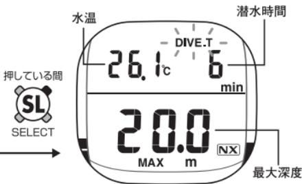
SELECTスイッチを押している間、上の画面を表示します。最大深度20.0m、水温26.1℃、潜水時間6分を示します。
