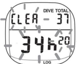
SETスイッチを押すと、CLEAとトータル潜水時間表示が点滅します。4～5秒押し続けると0h00になります。
