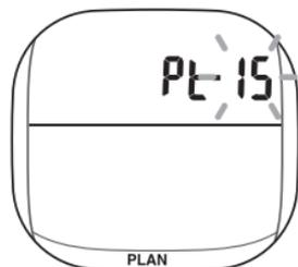
SETスイッチを押すとPt-15に切り替わります。その後、LOCKスイッチでダイブプランモードに戻ります。
