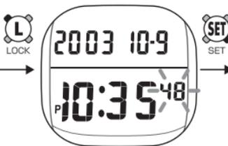
タイムモードからLOCKスイッチを押しタイムセットモードに移行すると、秒表示が点滅します。
