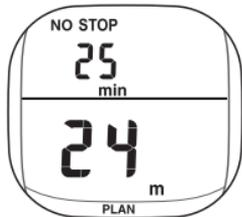
SELECTスイッチを1回押すごとに、深度ランクが3mずつ深くなり、そのランクでの無減圧限界時間を示します。表示は深度24mで無減圧限界時間は25分を示します。
