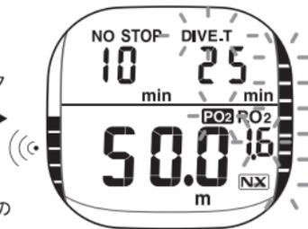
PO<sub>2</sub>値が1.6になると、3秒間のアラームが2回鳴り、PO<sub>2</sub>警告マーク、PO<sub>2</sub>値、O<sub>2</sub>バークラフが全点滅します。PO<sub>2</sub>値が1.5になるまで継続します。
