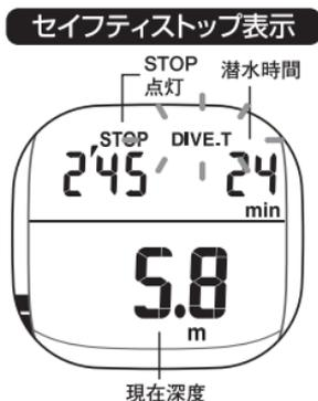
潜水時間24分で、深度5.8mに浮上したときの画面です。15秒のカウントダウンが済み、残り2分45秒を示しています。その後1秒単位で、カウントダウンが行われます。
