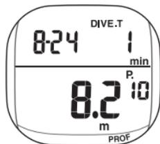
潜水時間1分経過時のダイブプロフィールです。深度が8.2mであったことを示しています。その後約30秒ごとの深度が潜水時間とともに表示され、ダイビングが終了(深度1.5mで計測終了)するまで自動表示します。
