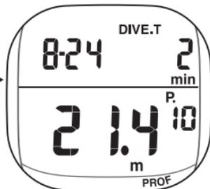
プロファイルを自動表示中に、SETスイッチを押し続けると、潜水時間のカウントアップを止めることができます。LOCKスイッチを1回押すとPC転送モード(90ページをご覧ください)、2回押すとSTEP1に戻ります。
