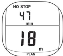
SETスイッチを1回押すごとに、深度ランクが3mずつ浅くなり、そのランクでの無減圧限界時間を示します。表示は深度18mで無減圧限界時間は47分を示します。
