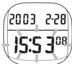
SETスイッチを押すと12時間表示/24時間表示が切り替わります。上図では、12時間表示(p3:53)が24時間表示(15:53)に変わりました。次にSELECTスイッチを押すと、秒修正に移行します。
