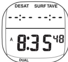
②の画面の時に、SELECTスイッチを押しと日本時刻を表示。上図では午前8時35分48秒。しかもバックライトが点灯するので暗闇でもバッチリ読める。
