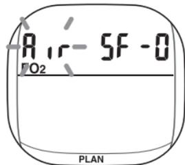
タイムモードからMODEスイッチを3回押しダイブプランモードに移行。LOCKスイッチを押すとダイブセットモードになります。出荷時の設定である $FO_2$ 値21%のAIR（圧縮空気）が点滅しています。
